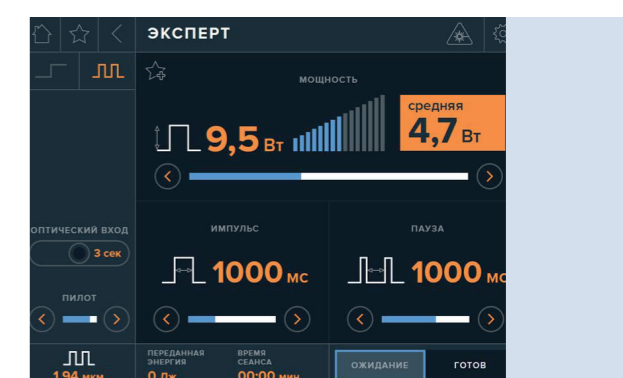
В режиме «Эксперт» пользователь может выбрать непрерывный или импульсный режим работы, задавать параметры мощности, длительности импульса и паузы
