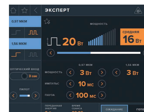
В режиме «Эксперт» FiberLase S позволяет регулировать подачу двух независимых излучений (0,97 и 1,55 мкм) через один волоконный инструмент
